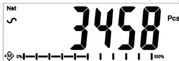
Kontrollwägung im Stückzählmodus
